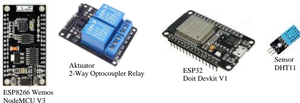
**Gambar 3. Modul Mikrokontroler dan Sensor/Aktuator**
